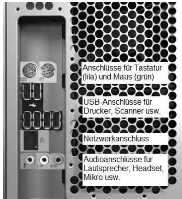
So etwa sieht ein PC von hinten aus. An diesen Buchsen schließt du weitere Geräte an. (Quelle: hp.com)
